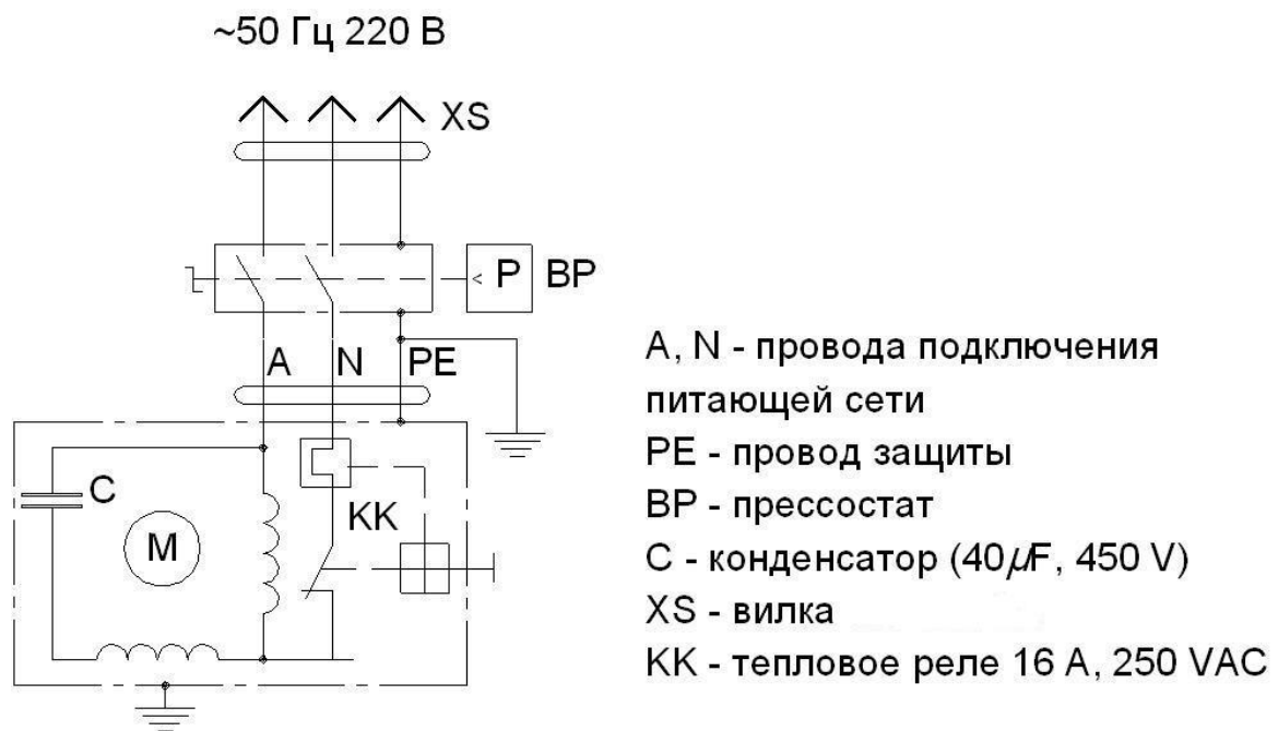
Рисунок 5 – Схема электрическая принципиальная СБ4/С-24.J2047В
